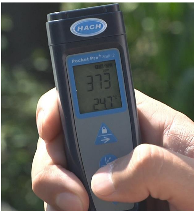
Слика 10. Теренско тестирање на водата со портабл инструмент HACH Pocket pro+
