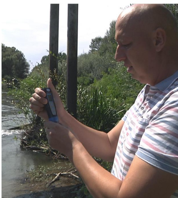
Слика 10. Теренско тестирање на водата со портабл инструмент HACH Pocket pro+
